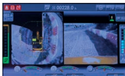
Med KomVision finns flera kameravinklar att välja mellan, tillsammans med "helikopterperspektivet" ovanifrån
