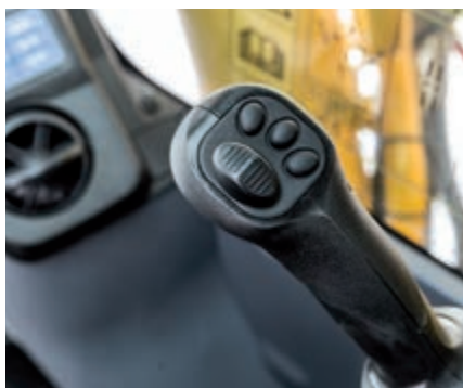
Bekväm, ergonomisk och precis kontroll: styrspakar med proportionell kontrollknapp för redskap
